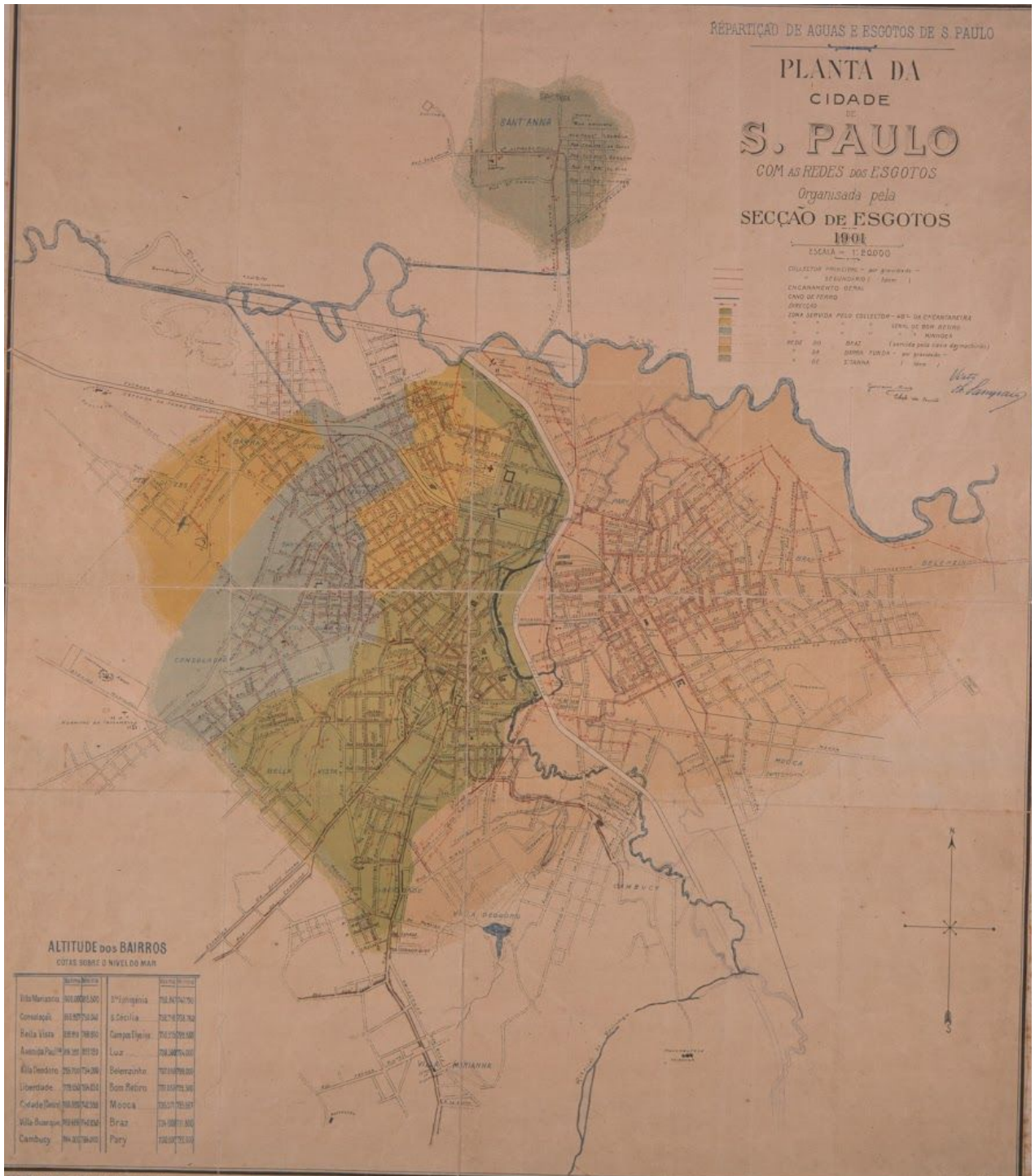
Planta da Cidade de São Paulo com a rede de esgoto, organizada pela Secção de Esgotos. Na parte superior, destacado na cor azul, é possível observar o Rio Tietê e seu curso. 1901. Notação: ELE.ENG.EST.013. Acervo Fundação Energia e Saneamento
